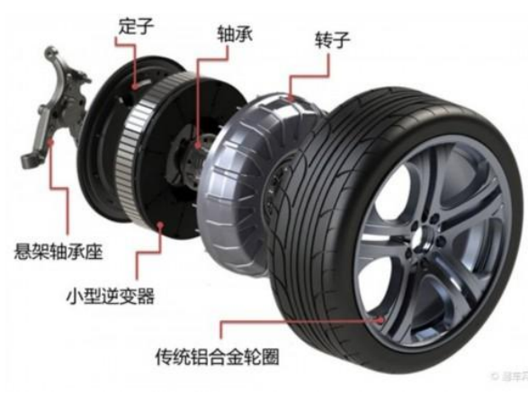
图 13: 轮毂电机结构示意图
