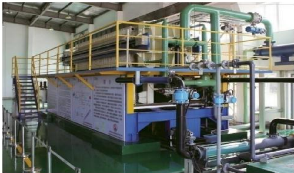
图表39 复洁环保低温真空脱水干化成套技术设备
