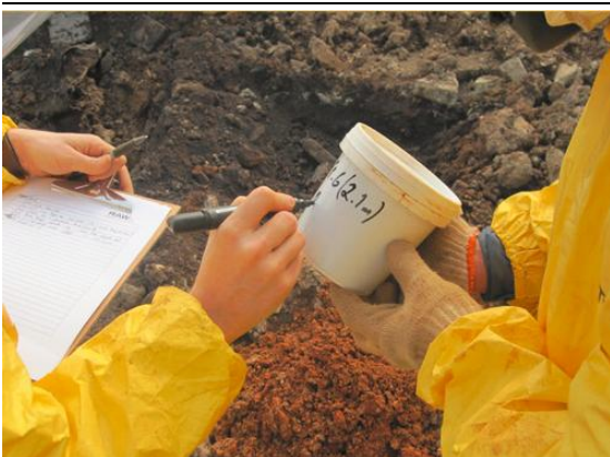
图 23: 污染土壤现场取样
