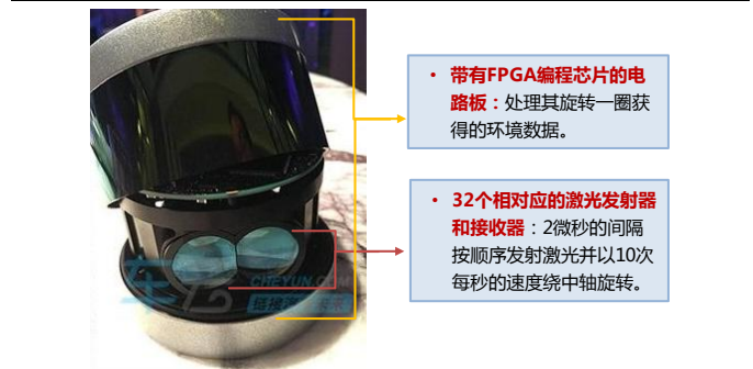
图14: Ultra Puck内部结构
