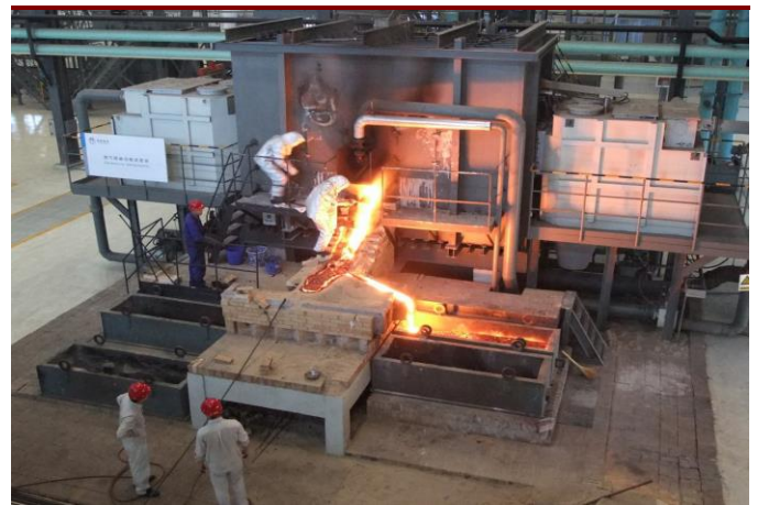
图4：神雾燃气熔分炉中试线出铁水
