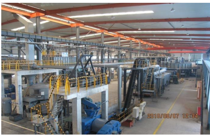
图3：神雾转底炉直接还原中试实验台
