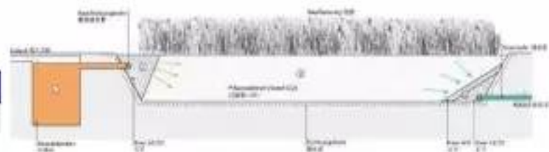
雨水沉降过滤系统
