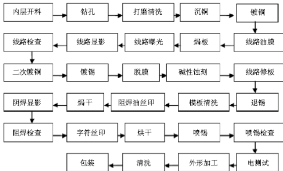
图4.11印制电路板（双面板）生产工艺流程图
