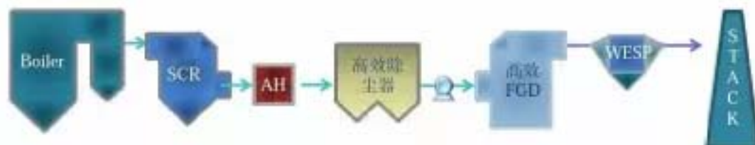
图 18 以湿式电除尘技术为核心的超低排放技术路线
