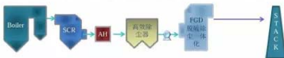
图 19 以脱硫除尘一体化技术为核心的超低排放技术路线
