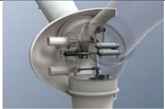
图 24: 变桨风机内部构造
