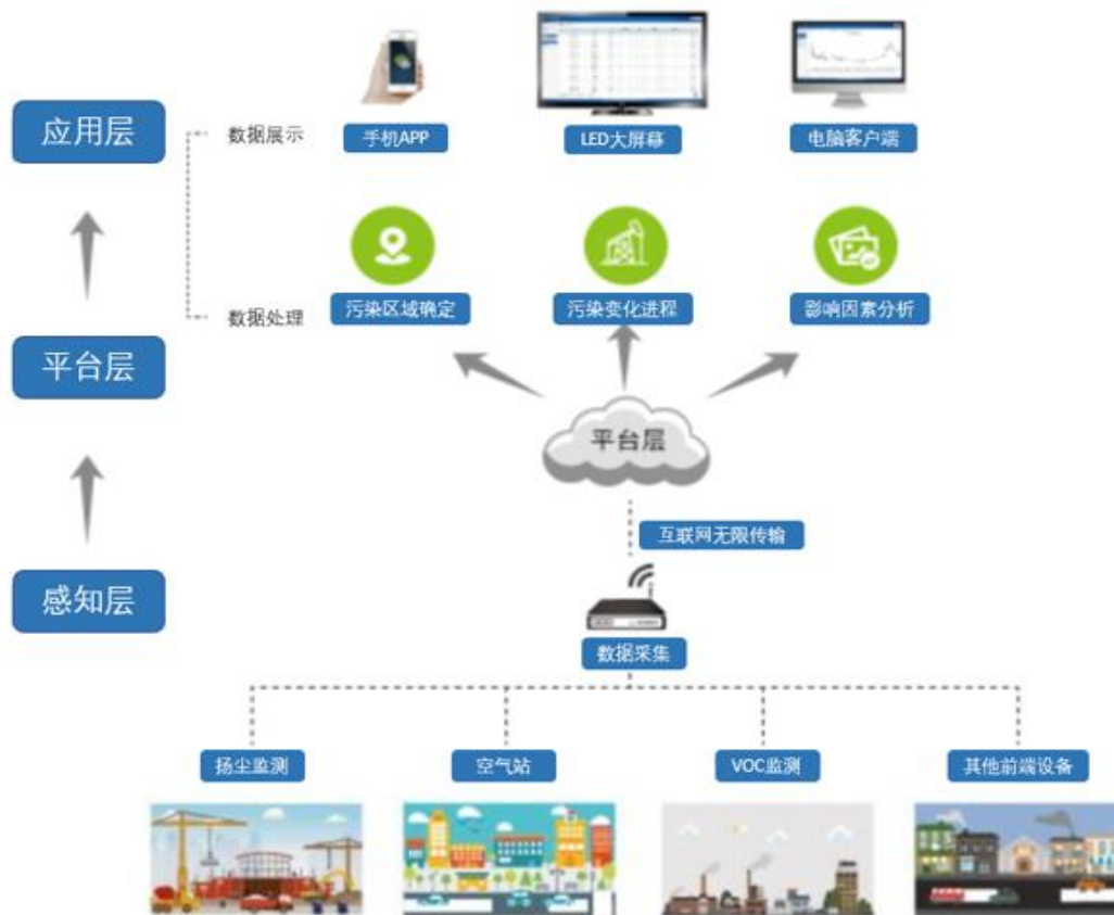
图表 35 大气网格化监测系统的结构示意图
