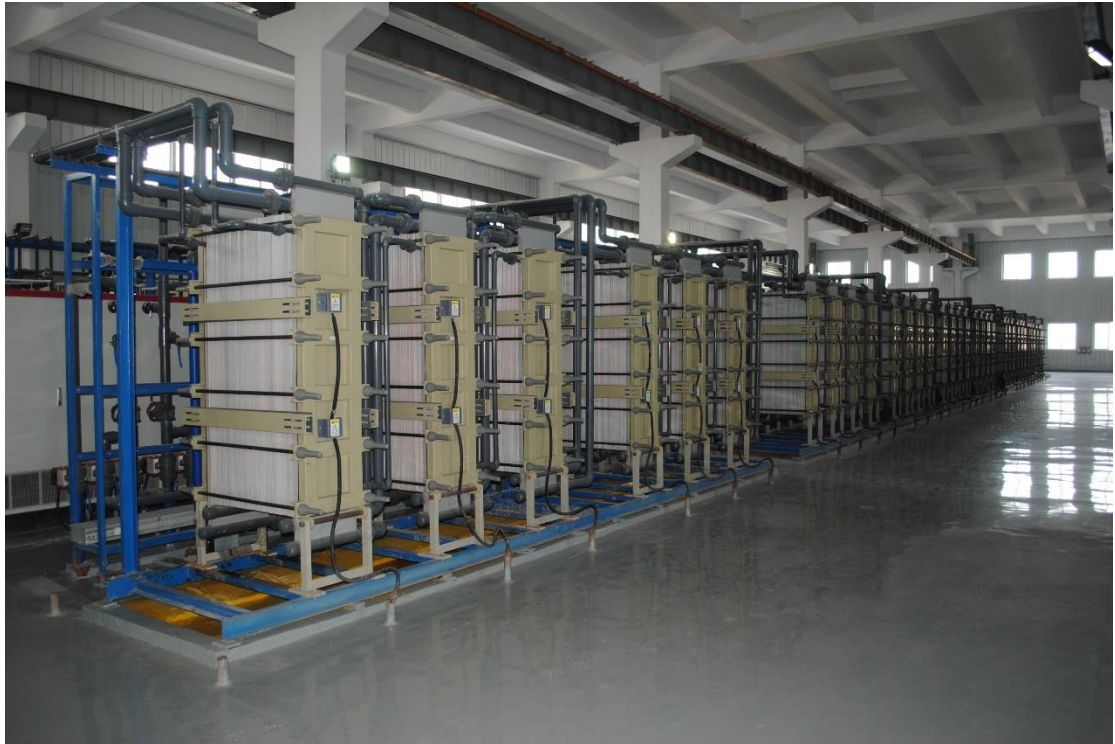
图 2 造纸废水零排放系统
