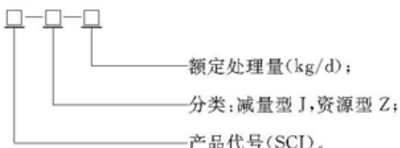
示例: 额定处理量为 1 000 kg/d 的资源型生物处理机, 型号标记为: SCJ-Z-1000。
