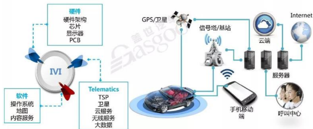
图 13：车载信息娱乐系统软硬件构成和服务方式
