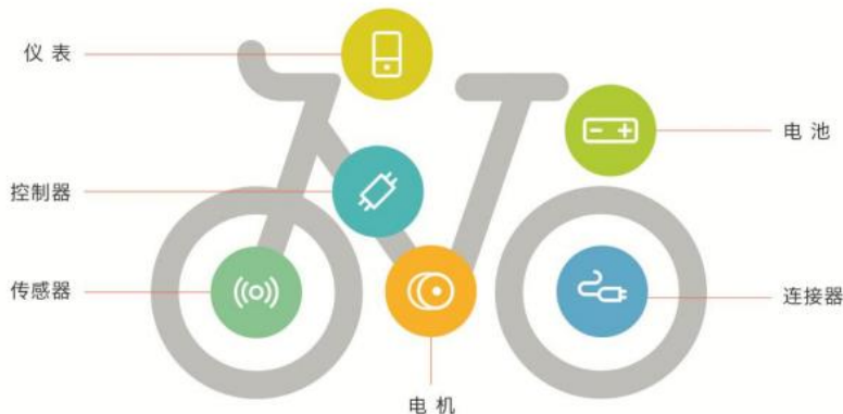
图、电踏车电气系统主要部件示意图
